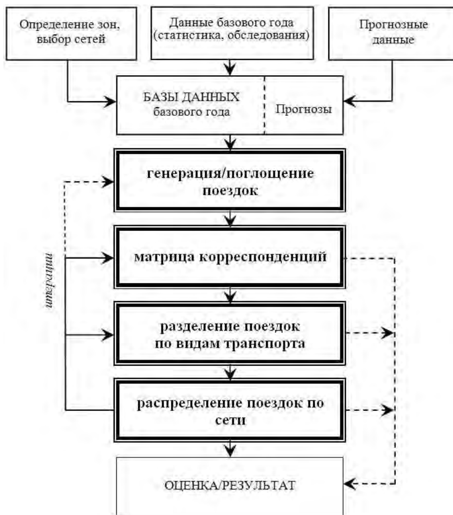
Рисунок 5.1- Архитектура классической 4-х ступенчатой транспортной модели
